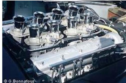
Très puissante, avec son V8 de 420 ch gavé par quatre carburateurs Weber double corps (la boîte de vitesses à cinq rapports est accolée au différentiel), la voiture fonctionne parfaitement. Même si l'habitacle est puissamment chauffé par le moteur et les échappements qui passent sous les portes... Après s'être fait admirer à Pebble Beach, à la Villa d'Este et à Goodwood où elle a gagné un premier prix, la 450 S Zagato revenait pour la première fois au Mans depuis 1957...
